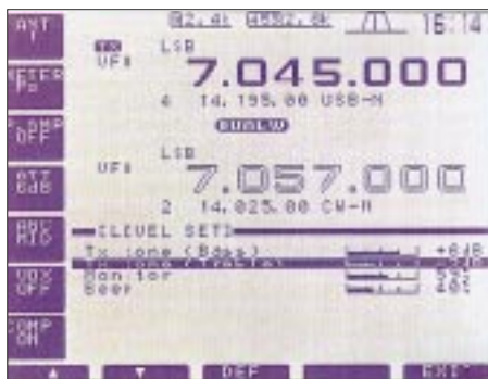
Bild 6: Das Menü „level set“ beeinflusst den Sendefrequenzgang. Die linken unteren Softkeys wirken als Up/Down-Tasten zur Auswahl, der Abstimmknopf ändert die Einstellungen.
